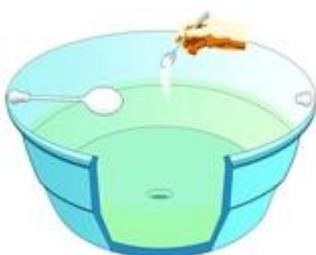
5 - Abra o registro de entrada de água, encha a caixa até a metade. Feche novamente o registro e a saída da caixa-d'água. Em seguida, adicione água sanitária conforme tabela abaixo:
