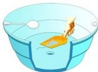
4 - Abra a saída da caixa para que escorra toda a água da lavagem. Usando um balde e uma pá de plástico, retire a água e os resíduos que restarem.
