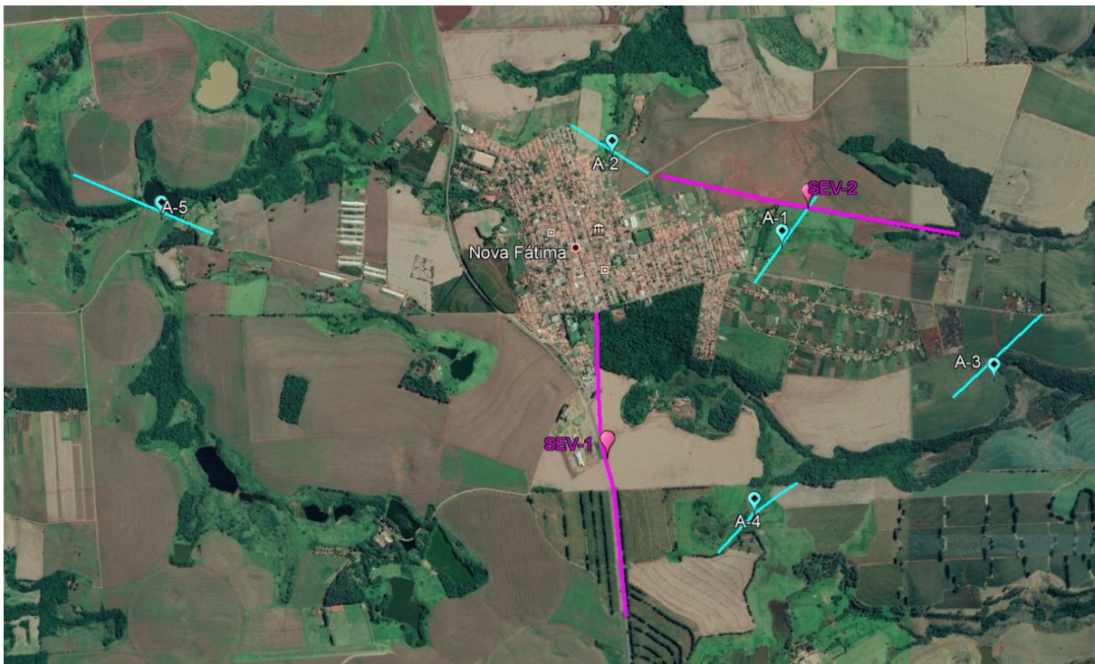
Figura 02 - Imagem ilustrando a localização da mancha urbana de Nova Fátima e o planejamento dos perfis geofísicos (em azul claro) de caminhamento elétrico para investigação do SASG, perfazendo 3.800 metros de levantamento. Em lilás tem-se a localização recomendada para a realização das Sondagens Elétricas Verticais-SEVs
